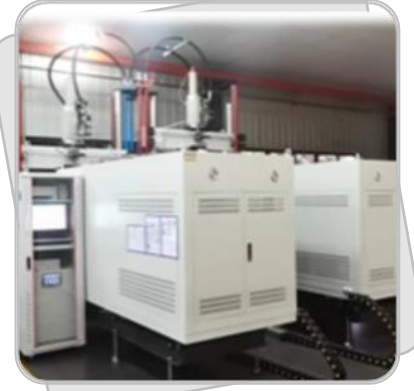
1/4 悬架耐久试验机 1/4 Suspension Durability Test
